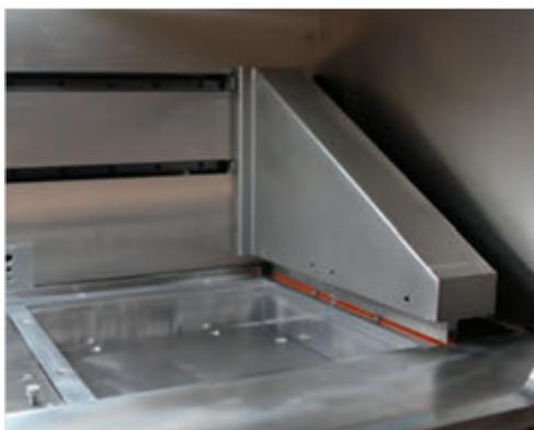
■ Sistema de deposición del polvo con cámara líquida (O)
